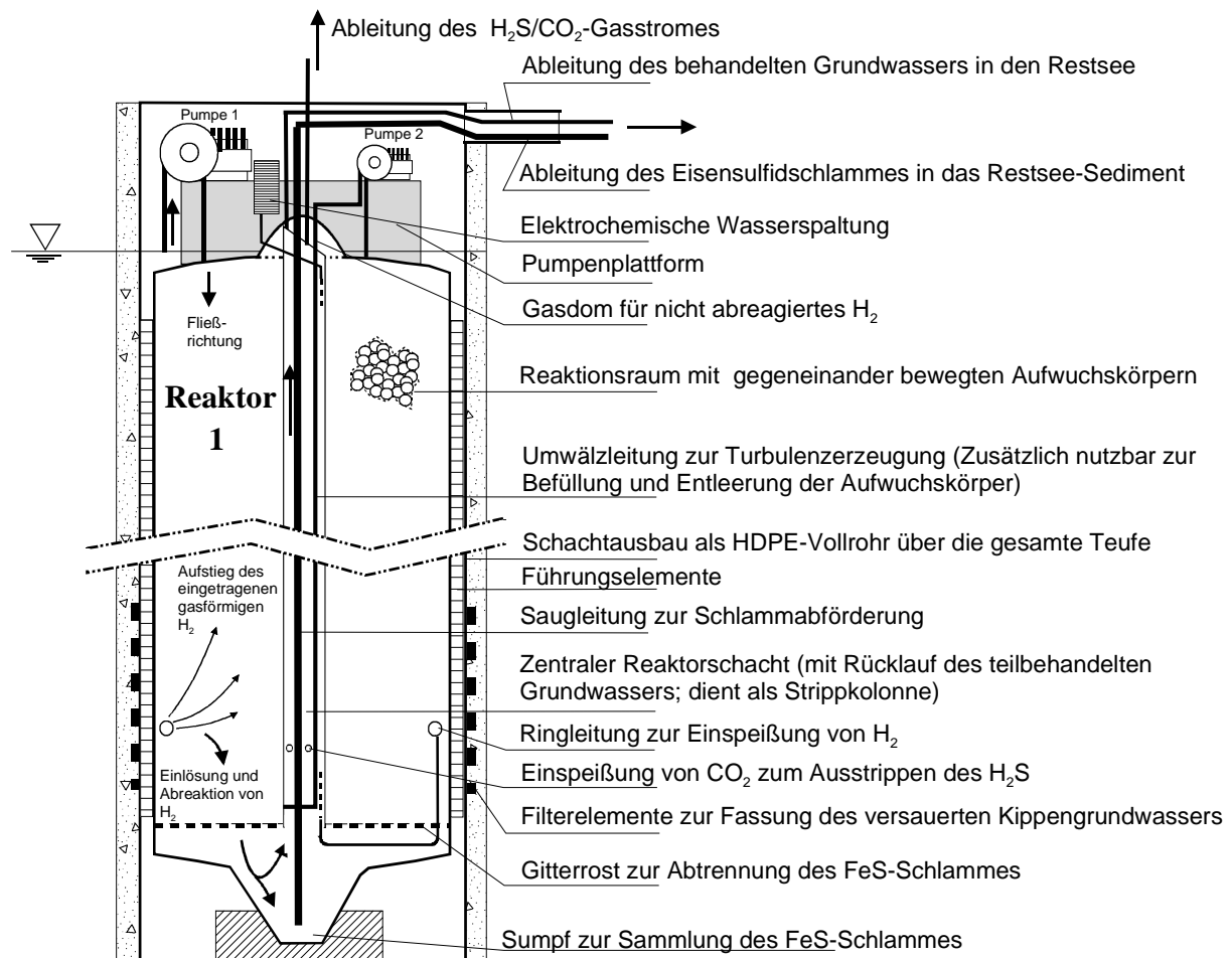
Abb. 1: Schematische Darstellung eines In-Situ Reaktors (1) in einer großkalibrigen Bohrung im Feldmaßstab.
