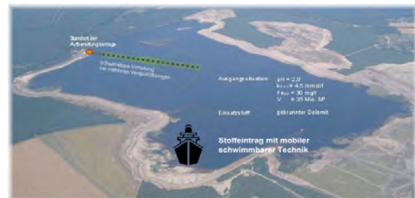
Abb. 4: Anpassung der Inlake-Technologie an unterschiedliche Seetypen durch mobile Technik (Uferttechnologie mit Suspensionsverteilung, fahrbare Silo- und Verteiltechnik).
