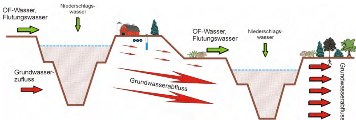
Abb. 7: Herstellung von Reaktiven Seewänden gegen GW-Versauerung: Gegenwärtiger Zustand.
