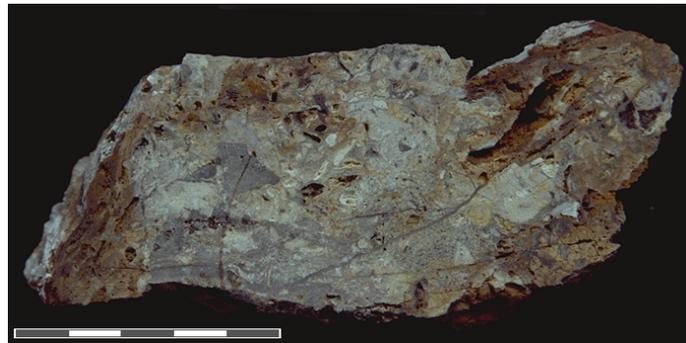
Abb. 28 Störungsbreccie mit Limonitvererzung aus einem Stollen westlich der Biberwierer Scharte. Die Komponenten sind teilweise durch Calcit miteinander verkittet. Limonit durchsetzt auch jüngere Frakturen. Maßstab: 5 cm.
