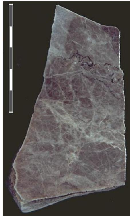
Abb. 52 Bituminöser, tektonisch beanspruchter Mudstone mit Lösungssutur. Die Risse sind in der späten Bildungsphase mit Calcit gefüllt. Maßstab: 5 cm.
