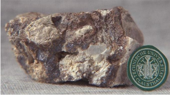
Abb. 23 Vererzte Breccie aus Wettersteinkalk. Die Zwischenräume der Komponenten sind durch Bleiglanz und Zinkblende ausgefüllt. Ein verbliebener Hohlraum enthält weiße, sattelförmige Dolomithkristalle sowie Calcit. Um die Zinkblende bilden sich braune Ränder aus Limonit sowie gelbe, erdige Anflüge von Greenockit (CdS). Aus der Privatsammlung Wolkersdorfer, Probe Nr. 19088101. Maßstab: 1,5 cm.
