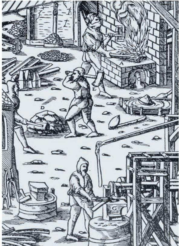
Abb. 6: Schmelzofen für die Eisengewinnung aus Agricola. Unterhalb des Feuers, mit C markiert, befindet sich der Schlackenausfluss.
