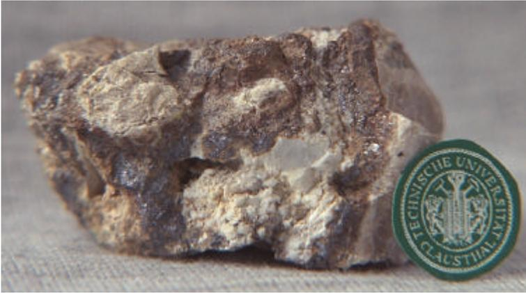
Abb. 21 Vererzte Breccie aus Wettersteinkalk. Die Zwischenräume der Komponenten sind durch Bleiglanz und Zinkblende ausgefüllt. Ein verbliebener Hohlraum enthält weiße, sattelförmige Dolomitekristalle sowie Calcit. Um die Zinkblende bilden sich braune Ränder aus Limonit sowie gelbe, erdige Anflüge von Greenockit (CdS). (Privatsammlung Ch. Wolkersdorfer, Probe Nr. 19088101). Maßstab: 1,5 cm.
