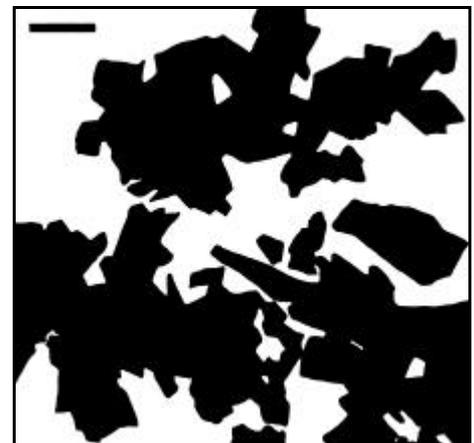
Abb. 77 Markasitkristalle wachsen unregelmäßig in einer karbonatischen Matrix (□ 86a). Maßstab: 0,1 mm.
