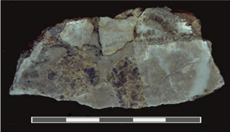
Abb. 22 Vererzte Breccie. Zu erkennen ist braune Zinkblende in einer feinkörnigen Karbonatmatrix sowie schwarzbrauner Limonit (♀ 184c). Maßstab: 5 cm.
