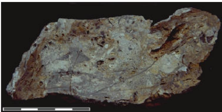
Abb. 26 Störungsbrecie mit Limonitvererzung aus einem Stollen W der Biberwiererscharte. Die Komponenten sind teilweise durch Calcit miteinander verkittet. Limonit durchsetzt auch jüngere Frakturen (☒ 182). Maßstab: 5 cm.
