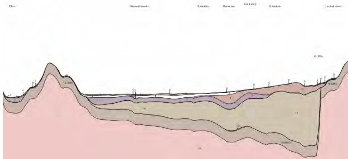
Abb. 4: Rechnerisch erzeugter und grafisch nachbearbeiteter hydrogeologischer Schnitt (Software GeODin 4.0)
