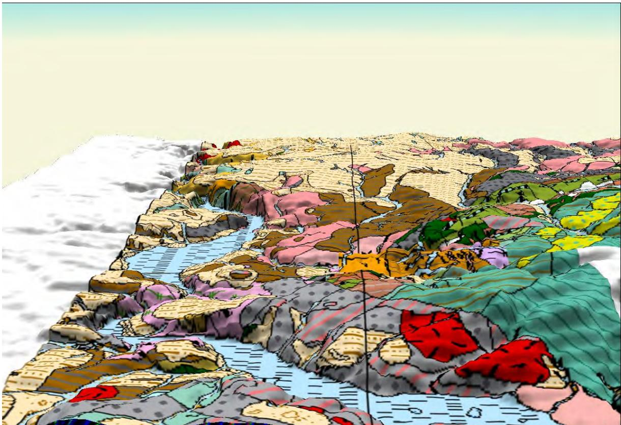
**Abb. 3:** Verschneidung der Geologische Karte mit dem digitalen Höhenmodell DGM25 zur besseren Darstellung der Verteilung quartärer Lockersedimente.
