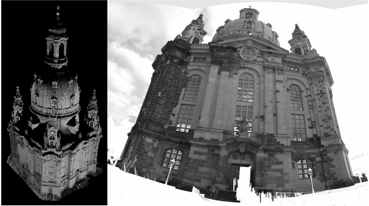
**Abb. 15: 3D terrestrische Laser Erfassung und RGB-Bilddatentexturierung.**
