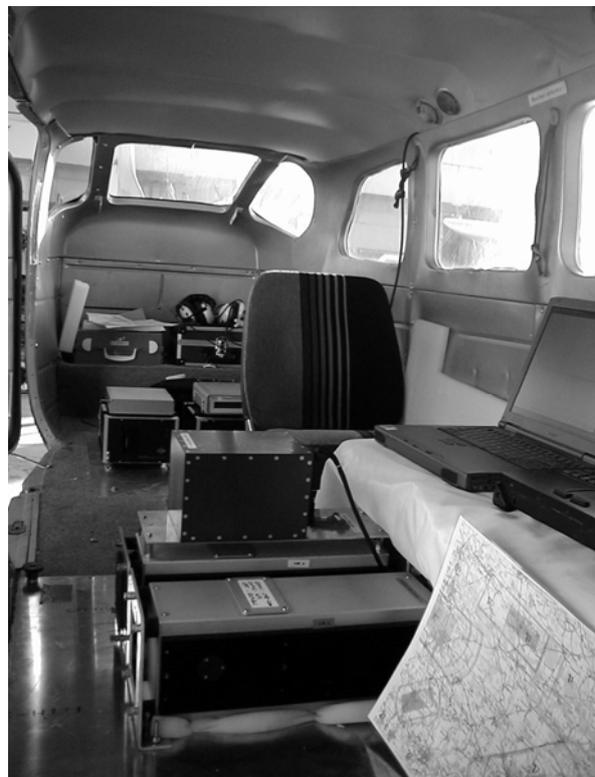
Abb. 2: (Innenraum Cessna 207 B, zwei Laserscannern sowie INS).
