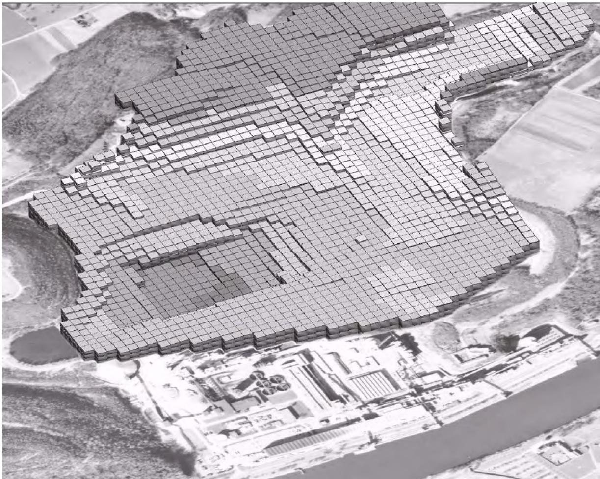
Abb. 3: Blockmodell zur Qualitätssteuerung einer Kalklagerstätte für die Zementherstellung.
