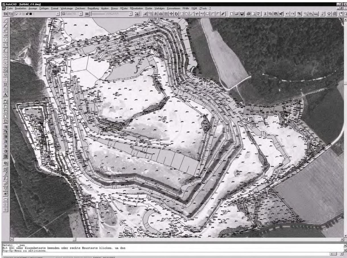
Abb. 2: Aerophotogrammetrische Auswertung eines Gewinnungsrisses mit Luftbildhinterlegung.
