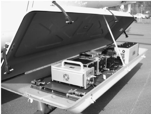
**Abb. 4: Eurocopter AS 350, Laserscansystemen sowie RGB-Digital-Framekamera & INS.**
