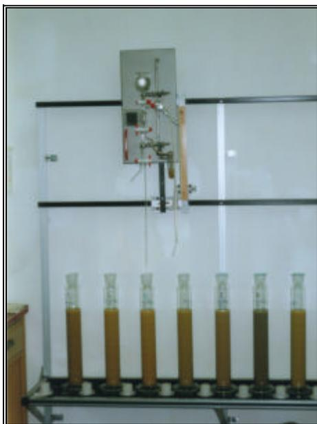
**Abb. 8:** Versuchsanordnung der KÖHN-Pipettierung.
